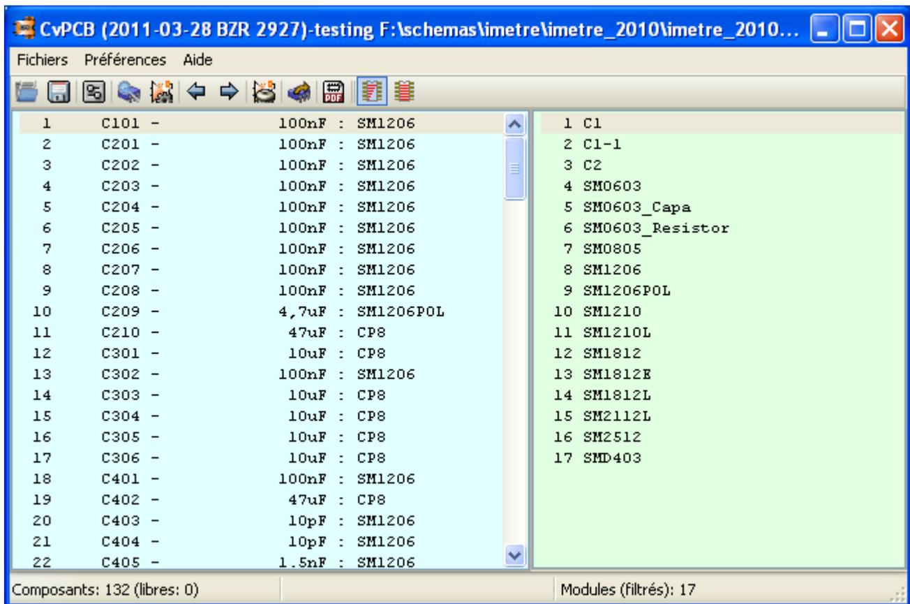
La fenêtre **Composants** (à gauche) affiche la liste des composants apparaissant dans la Netliste lue. La fenêtre **Modules** (à droite) affiche la liste des modules contenus dans les bibliothèques lues. La fenêtre **Composants** peut être vide si aucun fichier n'a été chargé, et la fenêtre **Modules** peut être aussi vide si aucune bibliothèque de module n'a été trouvée.
